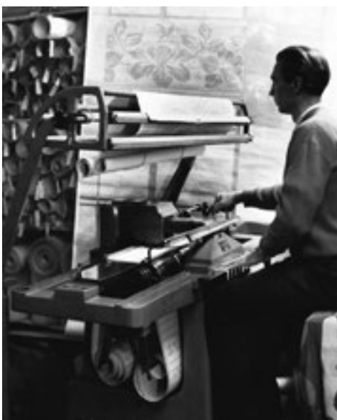
Abb. 14. Moderne Kartenschlagmaschine der Firma Zangs, um 1955
