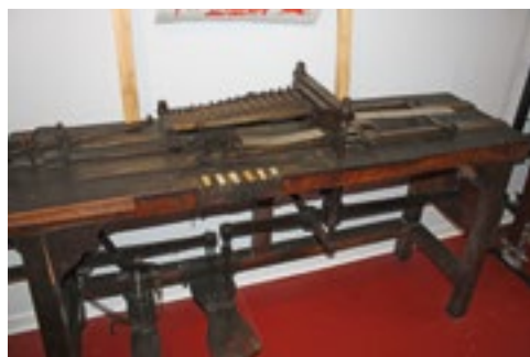
Abb. 3. 12-reihige Grobstichkartenschlag- maschine, Baujahr ca. 1900
