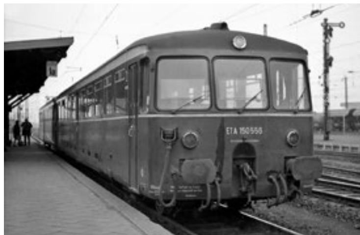
Abb. 4. Akkutriebwagen der Baureihe ETA 150 im Krefelder Hauptbahnhof auf Gleis 1a, kurz vor der Abfahrt nach Oberhausen (über Moers).
