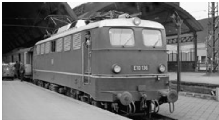
Abb. 5. Abfahrtsbereit steht auf Gleis 2 des Krefelder Hauptbahnhofs ein Eilzug mit einer damals modernen Lok der Baureihe E10 in Richtung Köln oder Duisburg. Der Elektro-Gepäckkarren steht auf dem Personenbahnsteig und nicht auf dem rechts sichtbaren, tiefer liegenden Gepäckbahnsteig zwischen den Gleisen 1 und 2.
