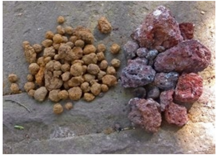
Abb. 9. Links ungeröstetes – rechts geröstetes Erz
