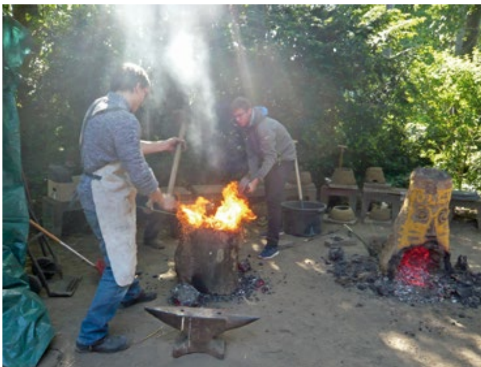
Abb. 20. Verdichten der glühenden Luppe
