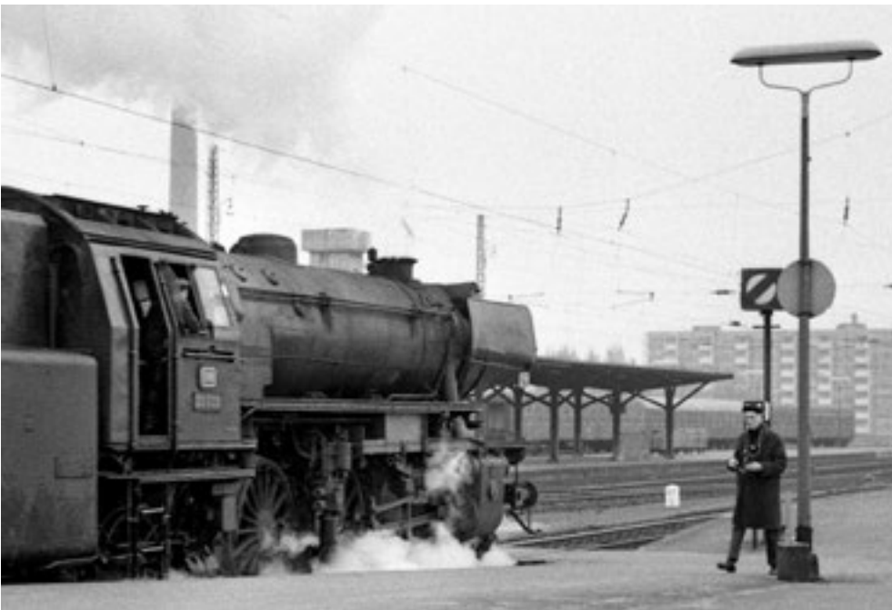
Abb. 8. Eine moderne Personenzuglok der Baureihe 23 (die Loks dieses Typs wurde in den 1950er Jahren gebaut) hat einen Zug von Kleve nach Krefeld Hbf gebracht. In Krefeld findet „Lokwechsel“ statt; von hier aus wird der Zug von einer Elektrolok nach Köln befördert. Die Dampflok ist vom Zug abgekuppelt worden und setzt sich in Richtung Bahnbetriebswerk (an der Dießemer Straße) in Bewegung. Die Schrägstellung des Balkens am Gleissperrsignal zeigt, dass es sich um eine „Rangierfahrt“ handelt. Dem unbekannten Eisenbahnfreund mit der Kamera ist wohl auch bewusst, dass bald keine dampflokbepannten Reisezüge mehr auf der Strecke nach Kleve fahren werden.
