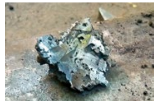
Abb. 21. Die abgekühlte durchgetrennte Luppe
