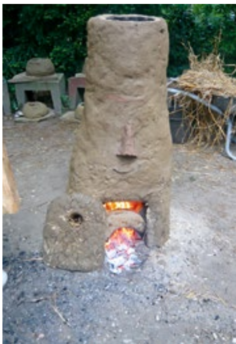
Abb. 13a. Der Ofen trocknet
