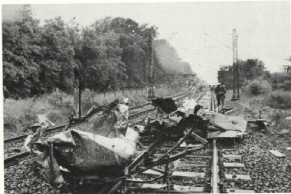
Abb. 2. Blick von der Strecke in Richtung Stellwerkgebäude am Bellenweg; rund 120 Meter wurden die Teile des Omnibusses vom Zug mitgeschleift
