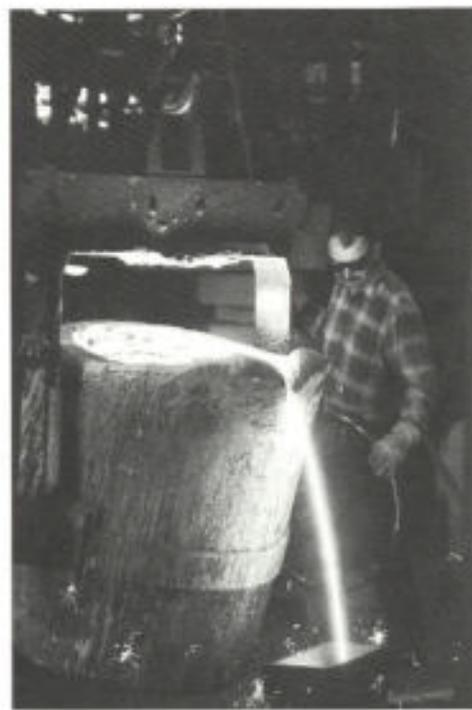
Abb. 9. Eingießen des flüssigen Eisens in die Gußform
