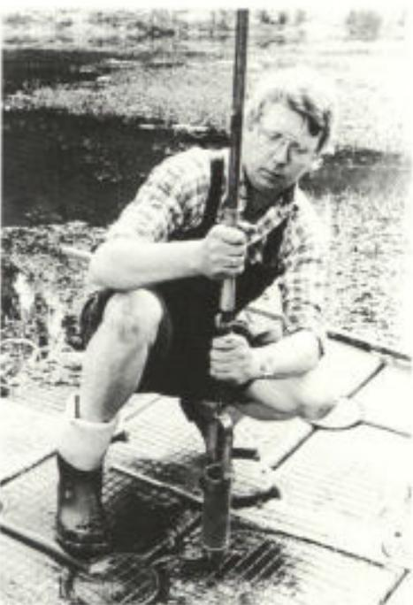
Abb. 5 und 6. Bodenkundliche Sondierungen im Linner Mühlengraben und im Bereich der Kuhlen
