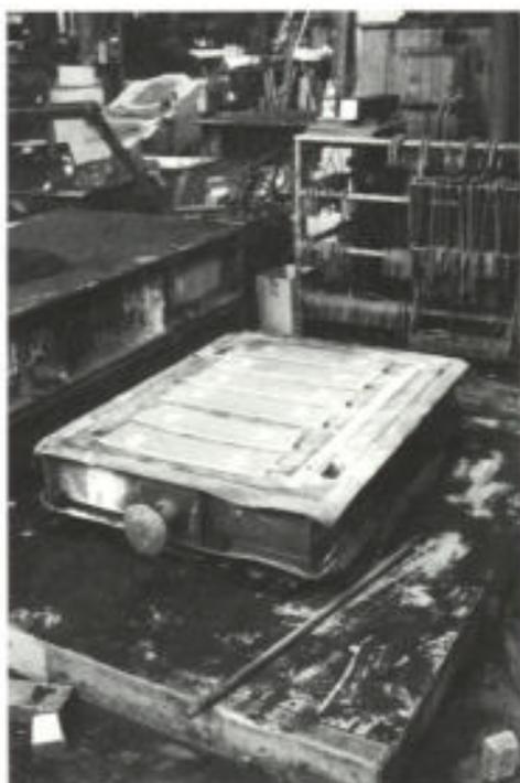
Abb. 7. Unterkasten mit den im festgestampften Formsand eingebetteten Modellen von vier geraden und zwei verschieden stark gekrümmten Elementen; am rechten Rand sind die Eingußöffnung und das Formteil für den Gußkanal sowie die Abflüsse zu den einzelnen Formstücken zu erkennen.
