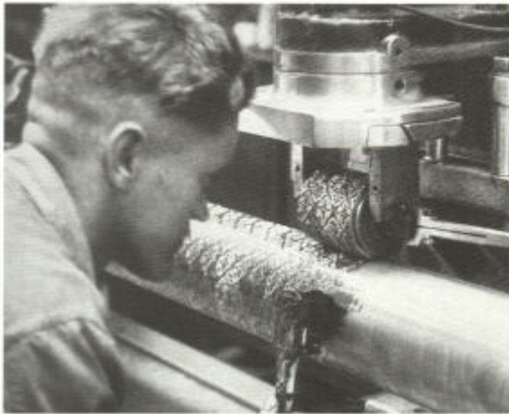
Abb. 12. Der Moletteur Peter Meder (geboren 1912 in Krefeld, gestorben 1998) von der Firma Dornbusch beim Einpressen des Musters der Molette auf eine Prägwalze, die nicht so stark gehärtet ist wie die Molette selbst. Die Prägwalze hat ein Vielfaches von Umfang und Breite der Molette. Durch Abwicklung der Molette auf den Umfang der Prägwalze und stufenweises Weitersetzen in der Breite entsteht das Gesamtbild des einmalig auf die Molette gravierten Rapports.
