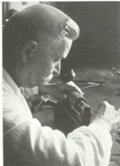
Abb. 11. Ein Mitarbeiter der Firma Dornbusch in Krefeld beim Gravieren einer Molette; um 1938. Der Graveur meißelt, sticht oder hämmer einen Rapport (Mustereinheit, die durch Wiederholung das gesamte gewünschte Prägemuster ergibt) in eine aus Werkzeugstahl bestehende Walze (Molette). Die Molette wird anschließend gehärtet und als Werkzeug verwendet. Mit Hilfe einer Spezialmaschine überträgt man das sich regelmäßig wiederholende Muster der Molette auf die eigentliche Prägwalze.
