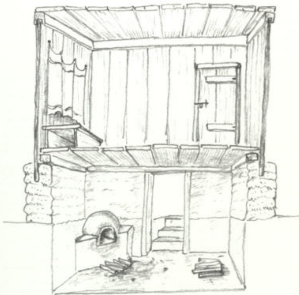
Abb. 14. Rekonstruktionsvorschlag für die dritte Phase des Heizsystems. Die aus Holzbohlen gefertigte Wärmekammer liegt jetzt über einem halbtiefen, mit Rasensoden-Wänden seitlich aufgehängten Heizkeller in der Diele.
